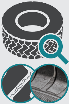
Praskliny mezi drážkami dezénu
